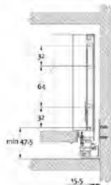
dimensões de instalação do painel do conector frontal
